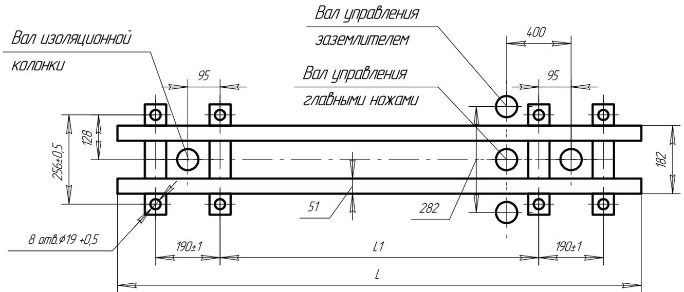
Рисунок 2. Разметка отверстий для крепления разъединителей (см. таблицу 5)
