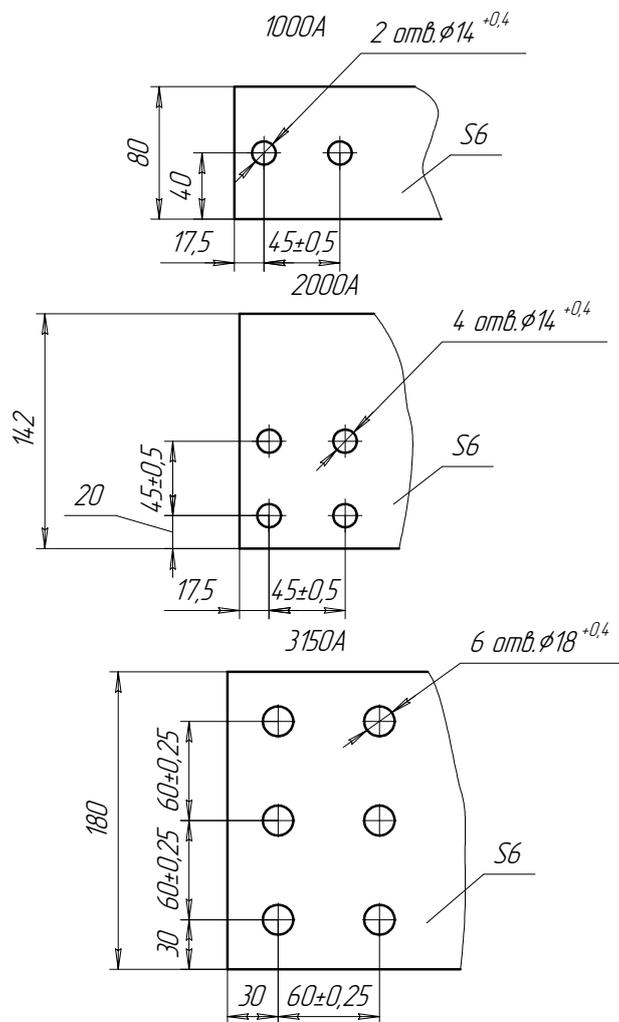
Рисунок 4. Разметка отверстий в контактном выводе разъединителя
