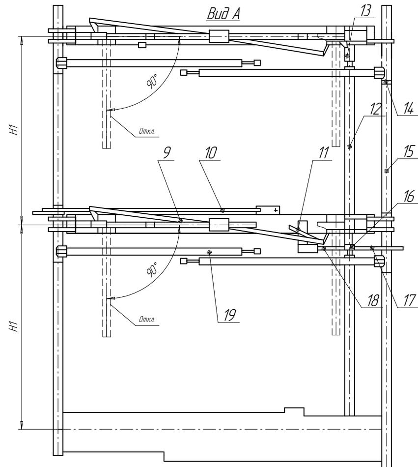
Рисунок 1. Габаритные, установочные и присоединительные размеры разъединителей РДЗ-110(Б), РДЗ-150, РДЗ-220(Б) (см. таблицу 4)
