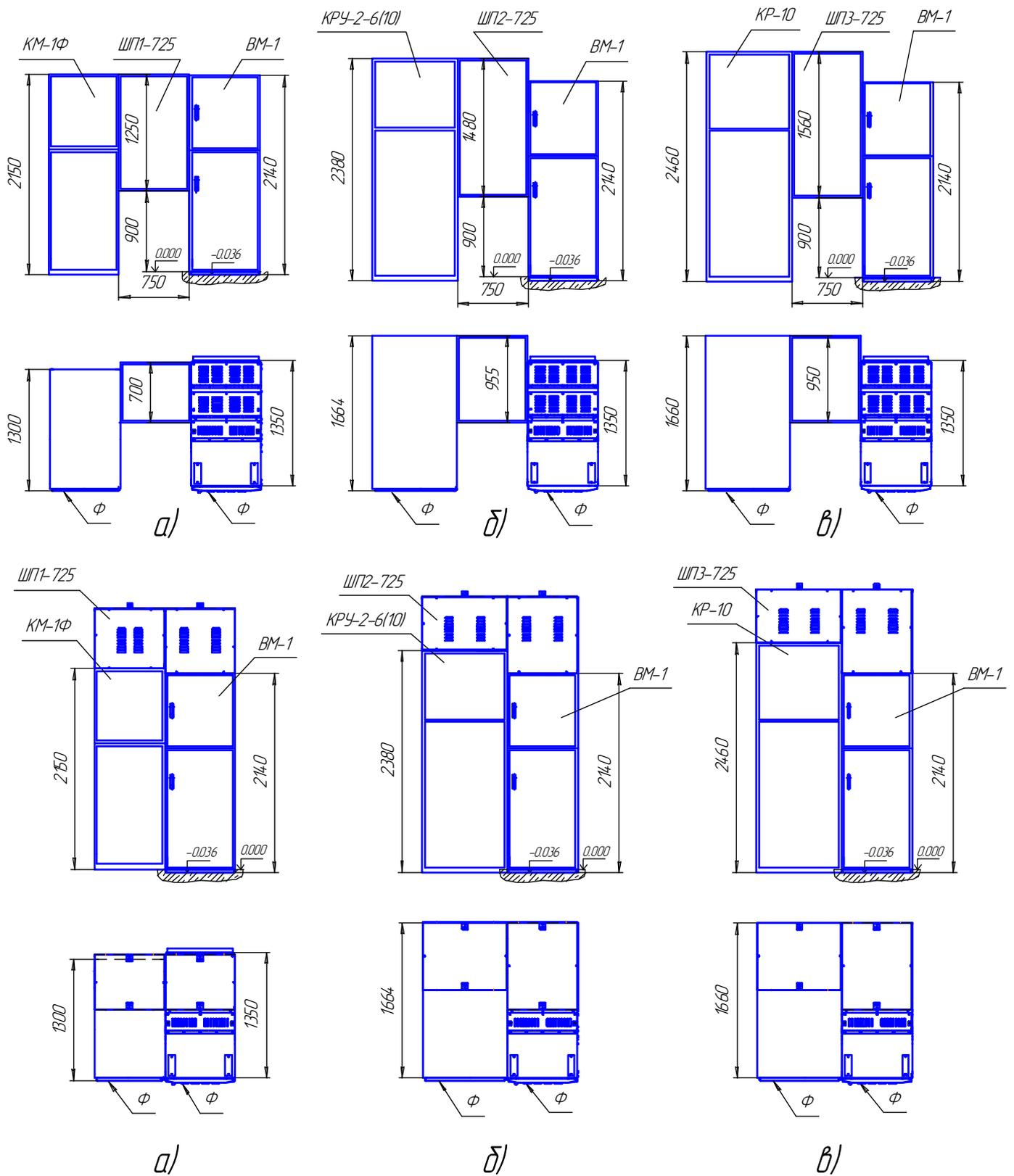
Рисунок 11. Габаритные, установочные и присоединительные размеры шинных переходов ШП (сх. 724, 725).
